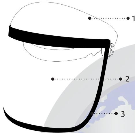
**1. CASCO:** Casco levantable donde va instalado el repuesto de esmerilar.
