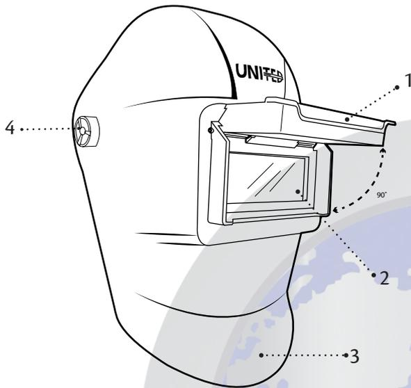
**1. VISOR OSCURO LEVANTABLE:** Este visor oscuro tiene la habilidad de levantarse en un ángulo de 90° y quedarse fijo en la parte superior.
